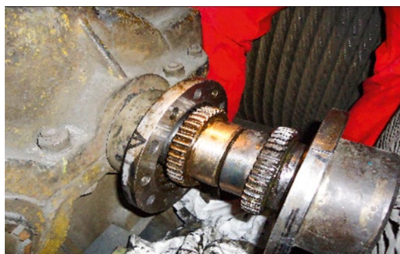
Zużycie sprzęgła zębatego – ubytek 30% pierwotnej
