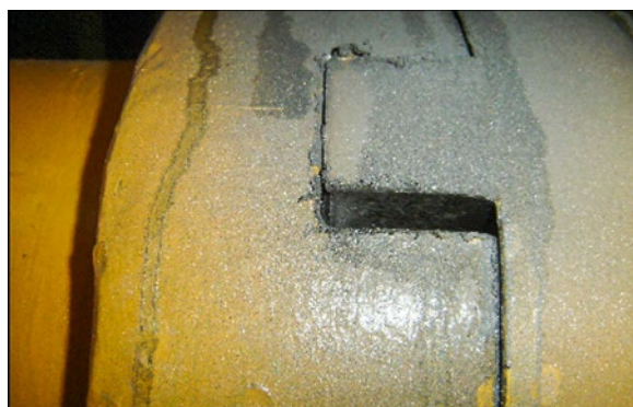
Zużycie wkładki sztywnej sprzęgła Olhama – luz 9mm grubości zęba
